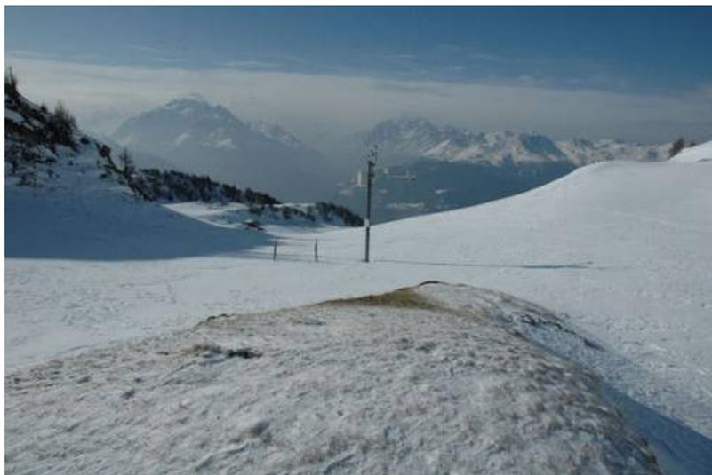
Abb. 7: Die IMIS Schneestationen liegen an gleichmässigen, eher windgeschützten Flachfeldern. Nur so kann sichergestellt werden, dass die Neuschneemengen normalerweise auch bei Wind erfasst werden. Die Schneehöhen sind an solchen Standorten tendenziell eher etwas höher als in der Umgebung. Schneestation MUN2, 2210 m, Mund, VS (Foto: P. Schwitter, 18.02.2007).
