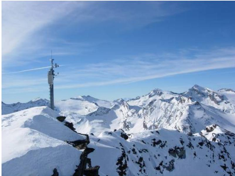
Abb. 6: Die IMIS Windstationen liegen auf exponierten Graten. Gemessen werden Lufttemperatur und –feuchte sowie Windgeschwindigkeit und –Richtung. Chilchalhorn, GR mit Blick zum Rheinwaldhorn, 3402 m, GR/TI (Foto: C. Gansner, SLF, 16.02.2007).
