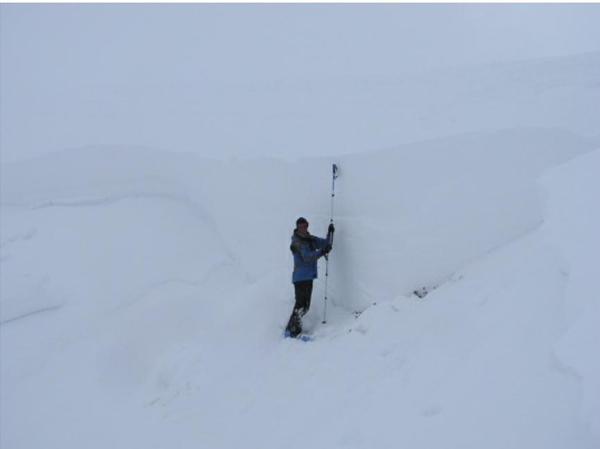
*Imposanter Anriss eines vom 12. auf den 13.1.08 spontan abgeganenen Schneebretts im Grossboda, Splügen, GR. Der Bruch erfolgte innerhalb der schwachen Altschneedecke (Foto: SLF/C.Pielmeier, 14.1.2008).*
