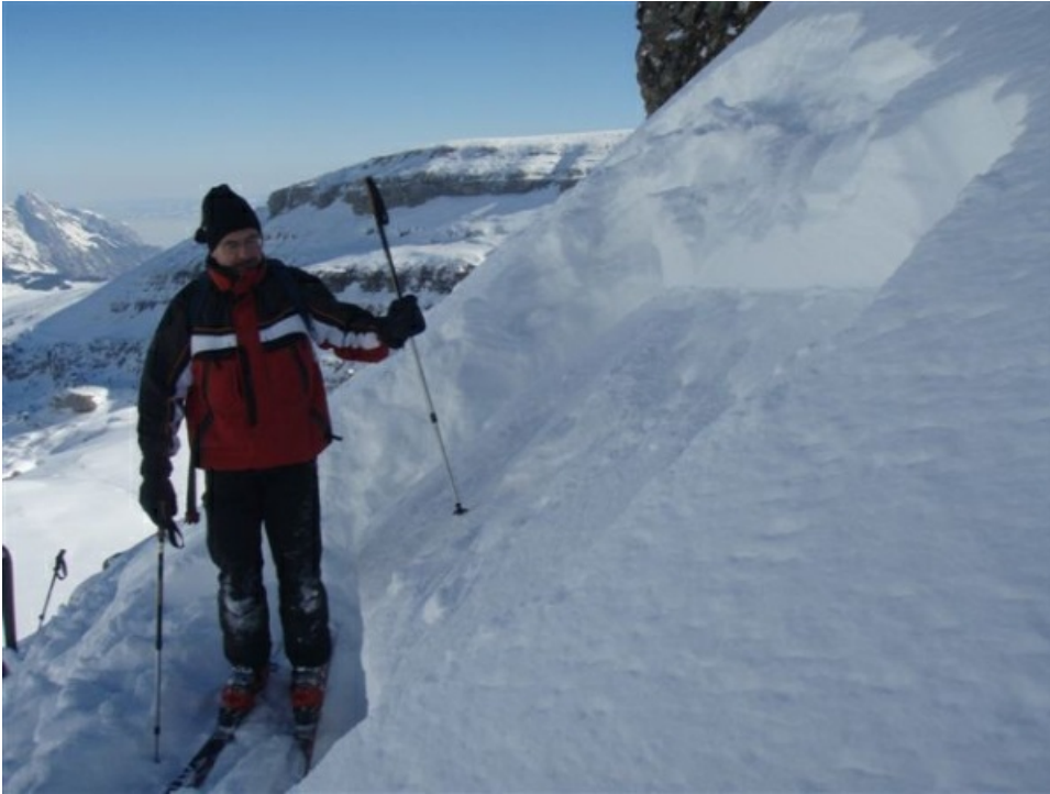
"Man braucht nur wackere Kerle mitzunehmen und schon löst sich der Schnee! Beim 2. mal Wippen rutschte doch etwas unerwartet der ganze Block ab." Grund war ein eingeschneiter Oberflächenreif. Chäser Rugg, Churfirten, SG (Foto: P. Diener, 16.2.2010).
