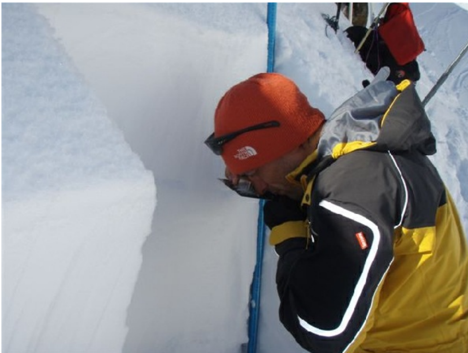
Abb. 3: SLF-Beobachter bei der Untersuchung der Schneedecke. Schwachschichten im Altschnee können teilweise durch rasche Setzungen oder Wummgeräusche vermutet werden. Die beste Methode, sie zu finden ist aber ein Schneeprofil mit einem Stabilitätstest an einer geeigneten Stelle (Foto: P. Diener, 29.03.2011).
