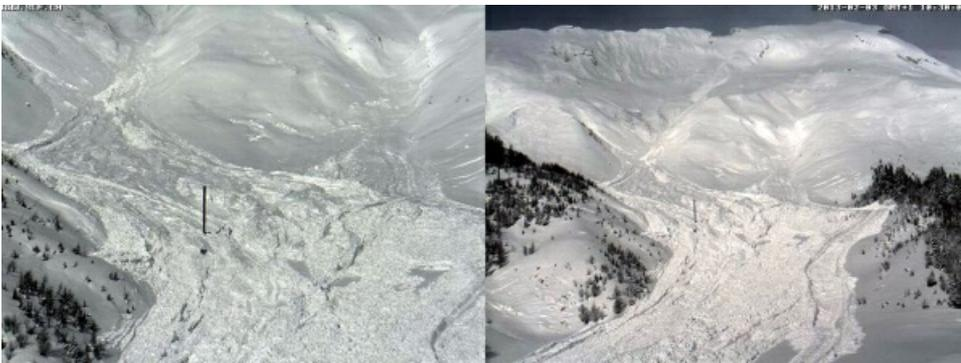
*Um 05:28 Uhr wurde im SLF-Testgelände Vallée de la Sionne (Arbaz/VS) der spontane Abgang einer grossen Lawine registriert. Die Lawine löste sich im Südosthang der Crêta Besse (2696 m). Im Bereich des Masten, welcher 20 m hoch ist, hatte sie eine Fliesshöhe von rund 5 m (Webcam Vallée de la Sionne/VS).*
