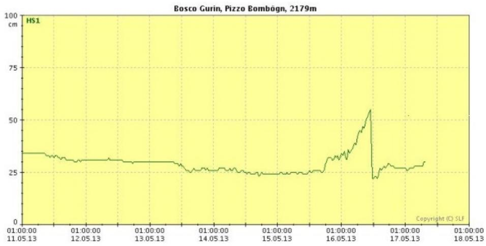
*Der Schneehöhenverlauf der automatischen Messstation in Bosco Gurin, TI auf 2179 m (Hangstation). Er zeigt den Anstieg der Schneehöhe am Donnerstag und die abrupte Abnahme um die Mittagszeit. Sehr wahrscheinlich rutschte der Neuschnee unter dem Schneehöhensensor auf der Altschneeoberfläche ab.*
