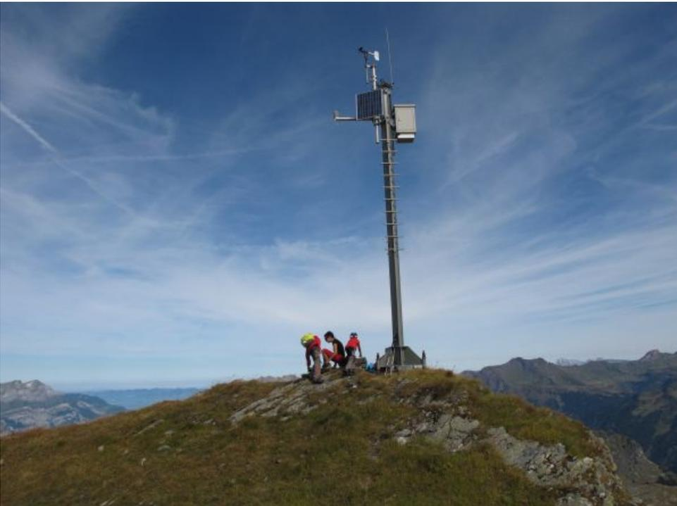
*Die Windstation auf dem Gipfel der Bliistögg (2448 m, Glarus Süd, GL) ist bereit für den Winter. Diese Windstation ist Teil des IMIS-Messnetzes (IMIS = Interkantonales Mess- und Informationssystem) (Foto: SLF/H.-U. Rhyner, 26.09.2013).*
