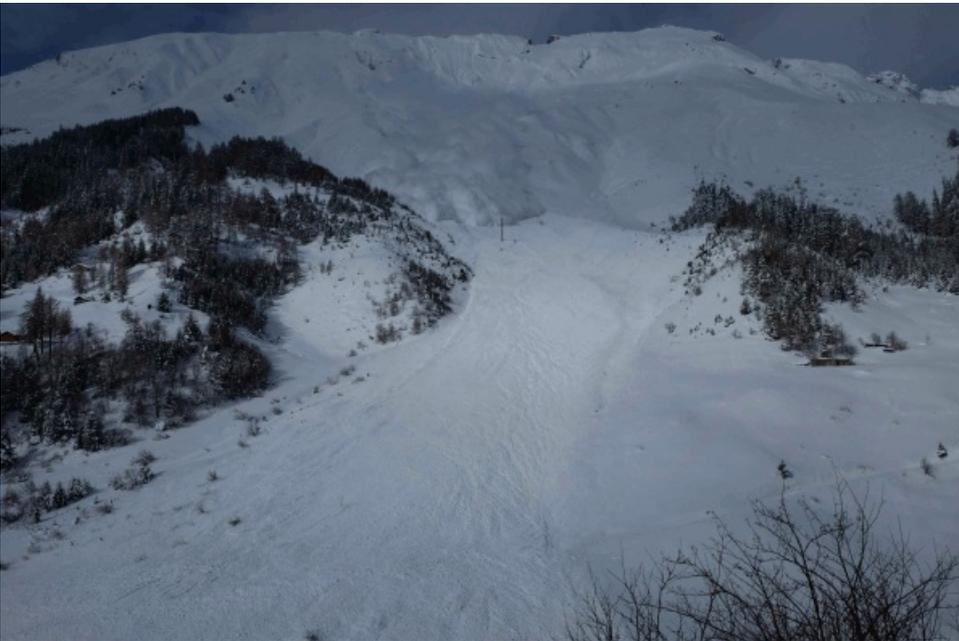
Abb. 9: Künstlich ausgelöste Lawine im Vallée de la Sionne (Arbaz, VS). Die Lawine überrollt in der Sturzbahn den mit Sensoren ausgerüsteten knapp 20 m hohen Masten. Nach den drei Lawinen betrug die Höhe der Lawinenablagerung am Mast 6 m (Fotos: SLF/M. Hiller, 03.02.2015).
